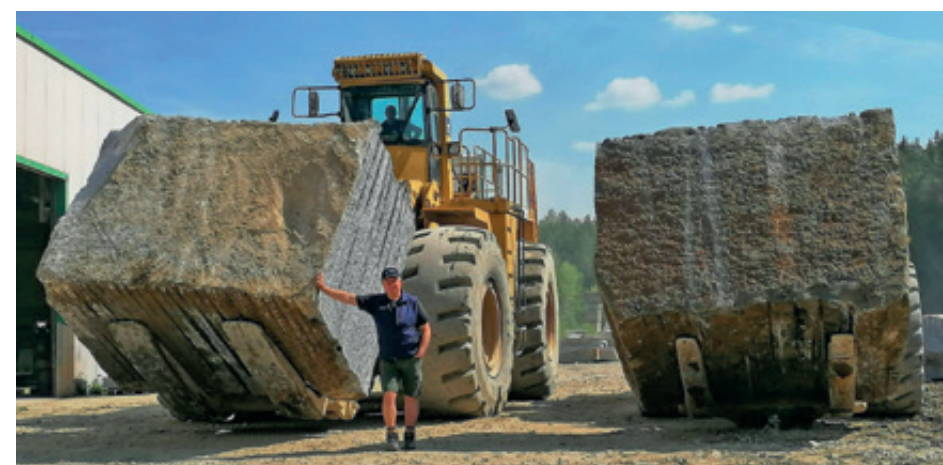
Immer wieder müssen die Trägerplatten und Traggabeln der Firma Baumaschinentechnik ihre Qualität auch bei schweren Brocken bis 100 t unter Beweis stellen.
